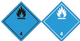
Danger d'émanation de gaz inflammable au contact de l'eau
