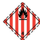
Danger de feu (matière solide)
